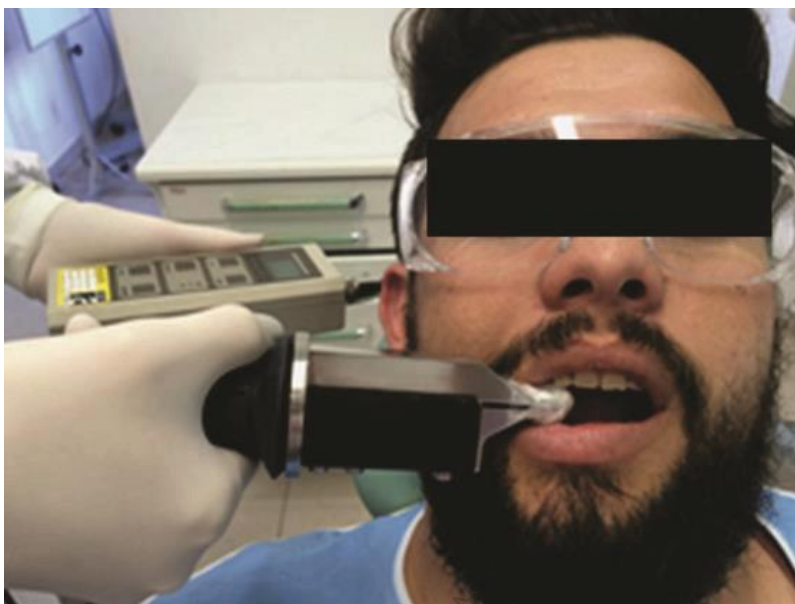
Рис. 8. Измерение силы укуса с помощью гнатодинамометра (прибор IDDK)
